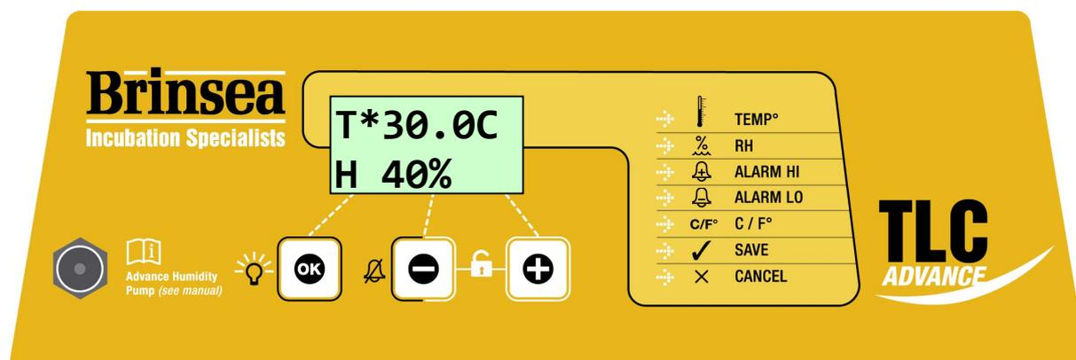
Das TLC Advance Kontrollsystem besitzt sehr präzise, individuell kalibrierte Sensoren für Temperatur und Luftfeuchtigkeit. Seien Sie vorsichtig bei der Verwendung von preiswerten Thermometern und Hygrometern, wenn Sie die Anzeigen des Displays vergleichen wollen.
